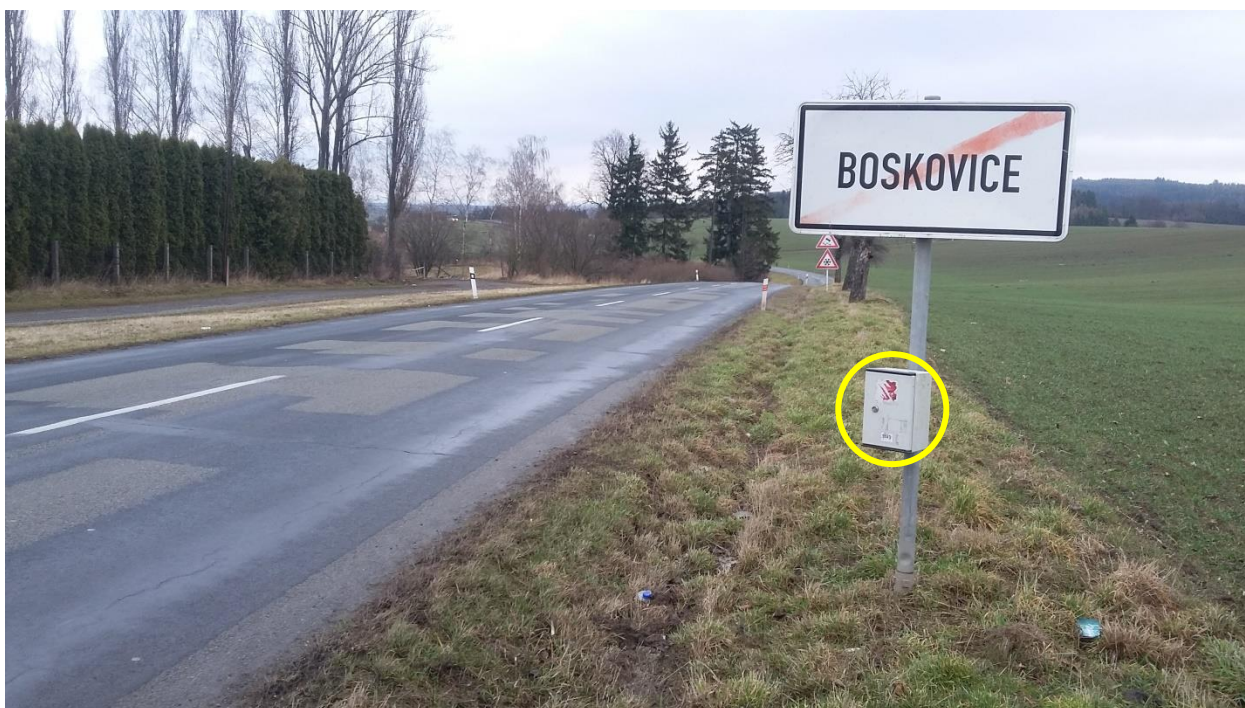
Obrázek 6: Radar na lokalitě 5 byl umístěn na silnici II/374 na dopravní značce IZ 4b Konec obce
