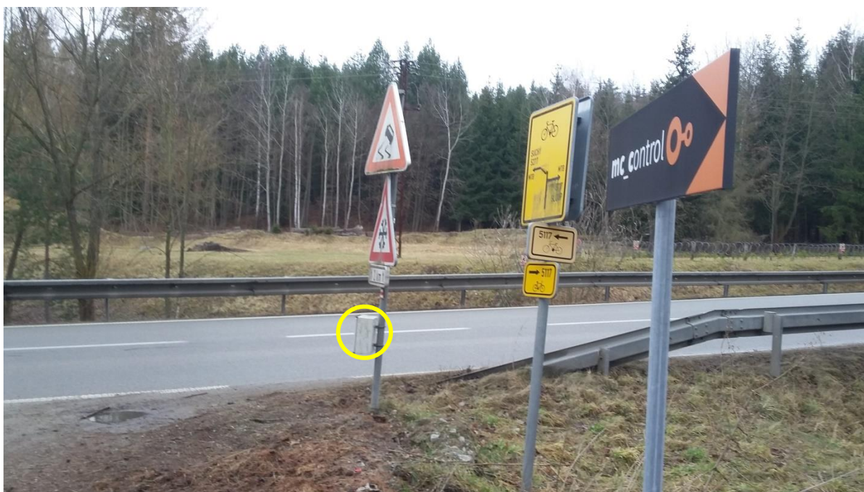
Obrázek 4: Radar na lokalitě 3 byl umístěn na silnici II/150 na dopravní značce A 8 Nebezpečí smyku a A 24 Náledí s dodatkovou tabulkou E 4 Délka úseku
